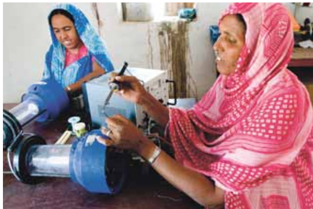
Haja Wallet Ousmane og Aminata Wallet Abdoul Aziz lodder kretskort til batteridrevne lykter. Loddebolten går også på strøm fra solenergi.
